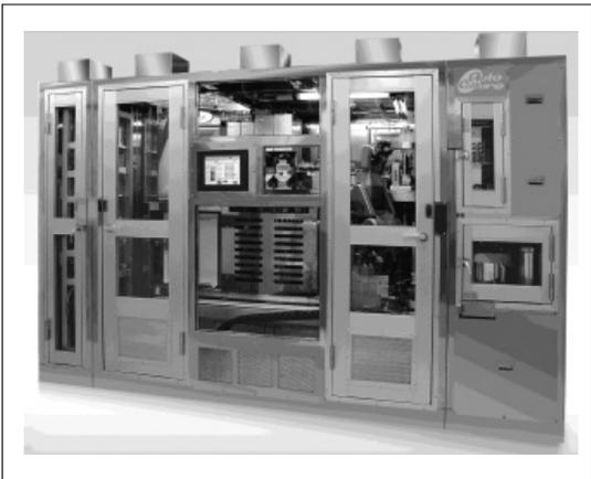
図6 創薬向けに開発した自動培養装置
